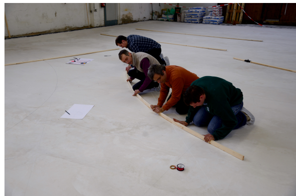
Fig. 15 : Tracé d'une épure au sol par Nicolas Eberhardt (appareilleur), Frédéric Degenève (responsable des ateliers de la Fondation de l'Œuvre Notre-Dame de Strasbourg), David Wendland (docteur et ingénieur) et Christian Mai (tailleur de pierre et historien de l'art), photographie de Maria José Ventas Sierra (Collaborateur scientifique des Projets REGothicVaultDesign et REGothicVaultElements (ERC) à la Technische Universität Dresden en Allemagne).
